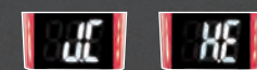
ジェットカウンターの呼出(外部入力) 搬送エラー(外部入力)
