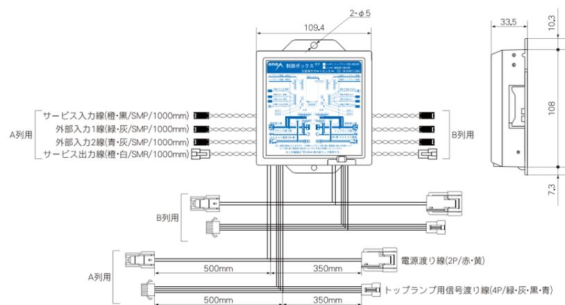
■制御BOX通信渡り線仕様外観寸法図(JU-2) ※単位:mm
